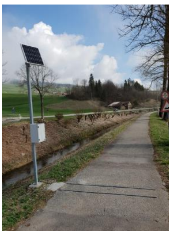
Figure 2-1 : Dispositif de comptage - compteur piézo-électrique
